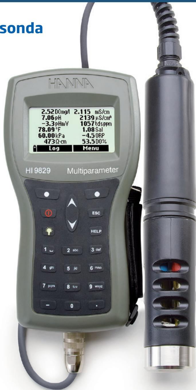
Sonda registradora con autonomía de 70 días y cable de hasta 20 metros
