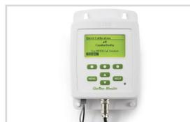
Una única solución de calibración para pH y conductividad hace que la calibración sea rápida y garantiza que todas sus mediciones sean precisas en todo momento para una mejor salud de la planta y un mejor rendimiento.
