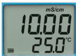
LCD. Multinivel El LCD grande muestra EC, temperatura, etiqueta de calibración, nivel de batería e indicador de inestabilidad.
