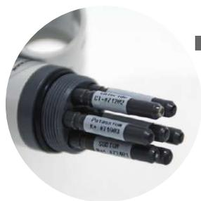
■ Sonda Multi Ion de 25 mm que incorpora electrodos selectivos individuales para cada ion.
